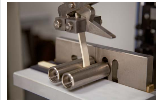
Dinamometro che misura la forza necessaria a separare il materiale morbido sovrastampato su un materiale rigido Dynamometer measuring the force necessary to separate a soft material overmoulded on a rigid material
