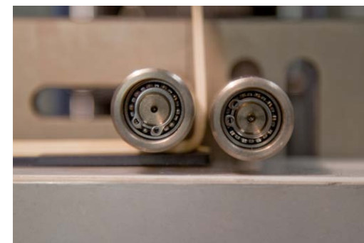
Dinamometro che misura la forza necessaria a separare il materiale morbido sovrastampato su un materiale rigido Dynamometer measuring the force necessary to separate a soft material overmoulded on a rigid material
