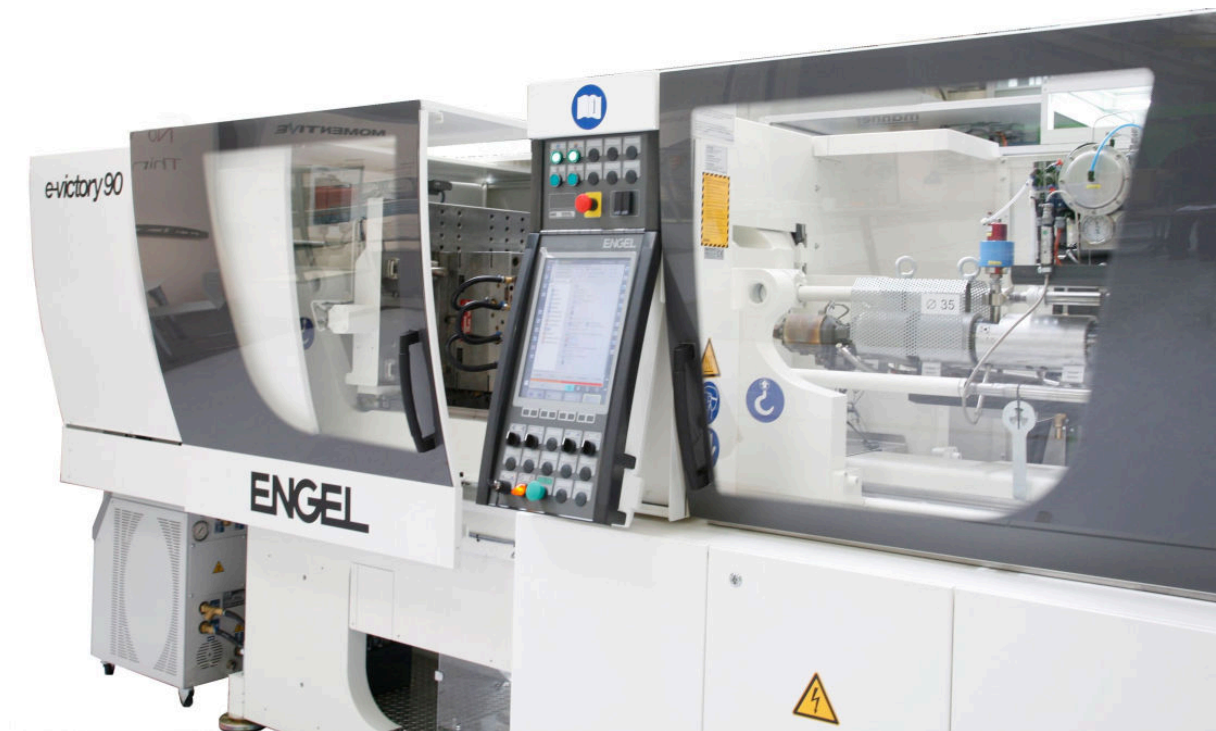
Una ENGEL e-victory 310/90 equipaggiata con il sistema MuCell di Trexel totalmente integrato.
